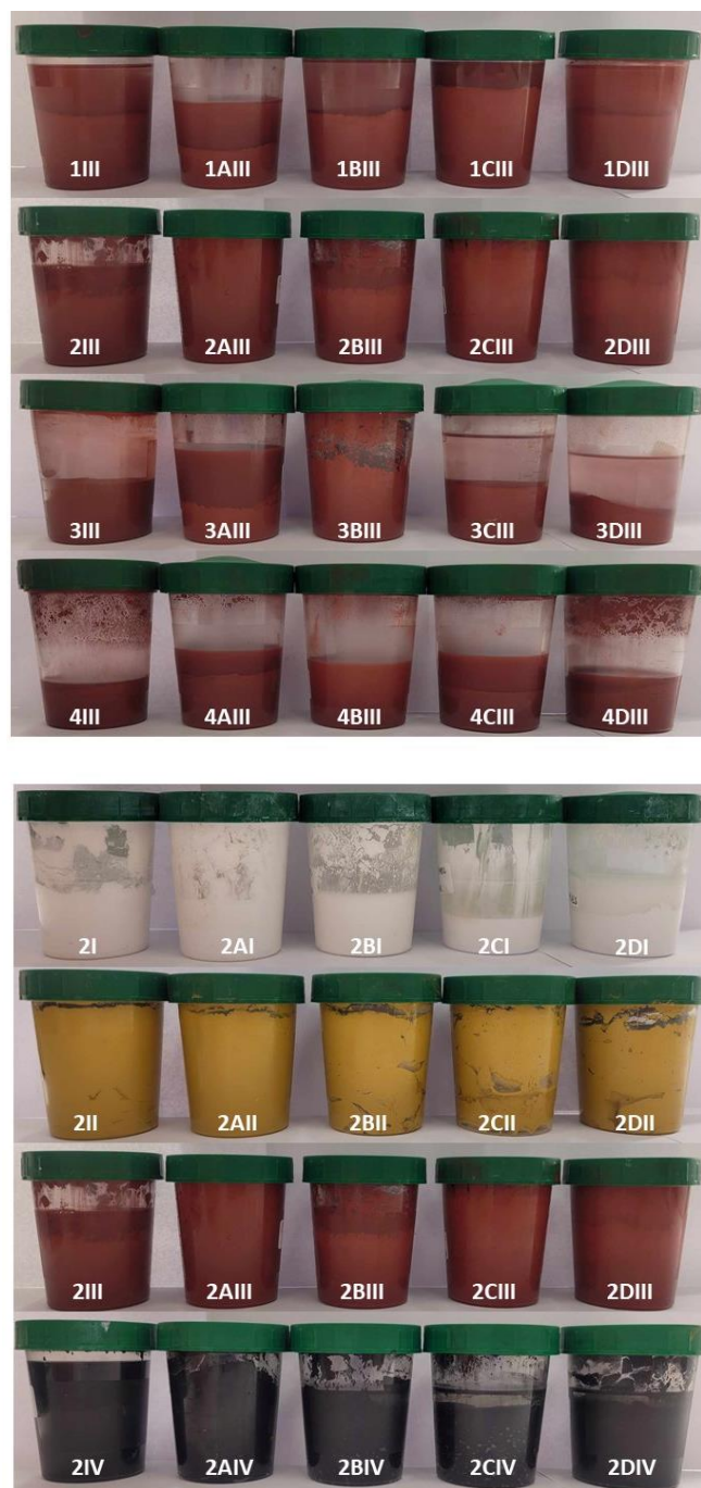
Rys. 48. Zdjęcia układów dyspersyjnych po okresie rocznego składowania.
