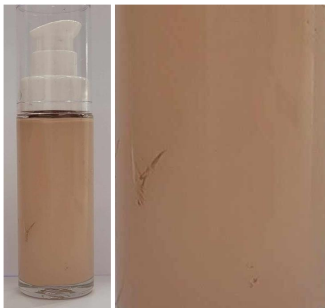
Rys. 46. Zdjęcie fluidu z defektem w postaci czerwonej smugi od pigmentu.
