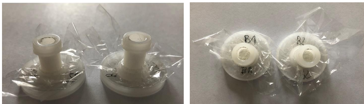
Rys. 38. Próbki badane w kubeczkach pomiarowych ED-XRF z folią polipropylenową.
