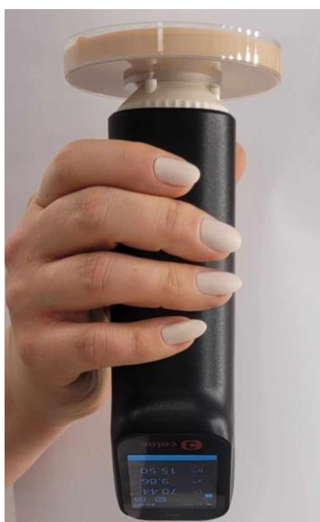
Rys. 53. Pomiar kolorymetryczny wykonany przy użyciu szalki Petriego.
