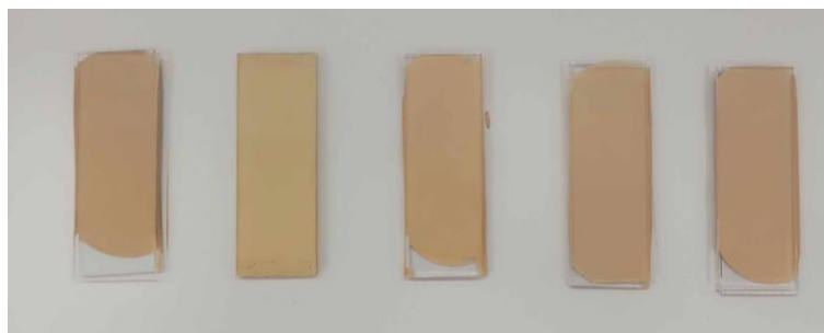
Rys. 54. Próbkki fluidów przygotowane na szkiełkach mikroskopowych.
