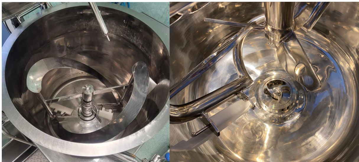
Rys. 44. Zdjęcie aparatu procesowego z mieszadłem wstęgowym i homogenizatorem w dnie zbiornika.
