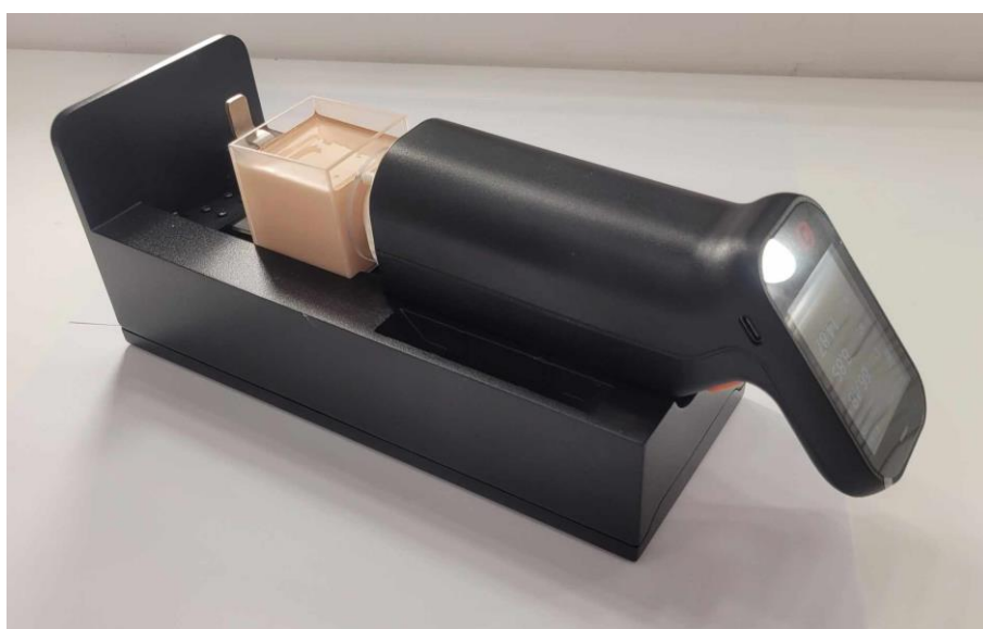
Rys. 51. Pomiar masy fluidu wykonany przy użyciu szklanej kuwety i statywu do spektrofotometru SV300.
