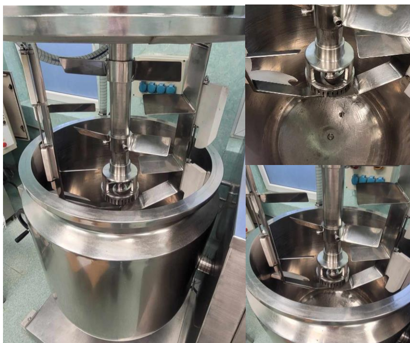
Rys. 45. Zdjęcie aparatu procesowego z homogenizatorem nasadowym.
