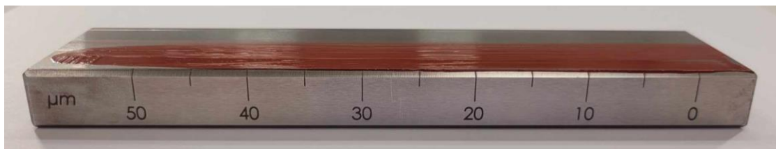
Rys. 47. Pomiary wielkości cząstek dyspersji wykonywane na grindometrze.
