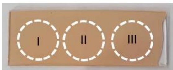
Rys. 55. Zobrazowanie miejsc przyłożenia przesłony pomiarowej na szkiełku mikroskopowym.
