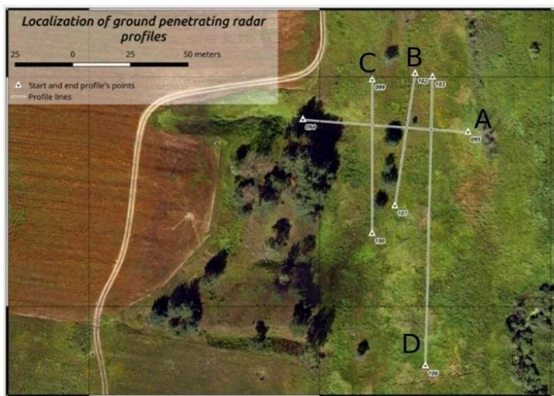
Rys. 12. Lokalizacja profili georadarowych na obszarze stożka akumulacyjnego A i B. Ortofotomapa wykonana przez E. Kazakova, profile wykonane przez E. Pavlovskaią
