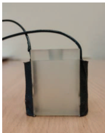
Rysunek 4. Cella do pomiaru szybkości propagacji fal ultradźwiękowych
